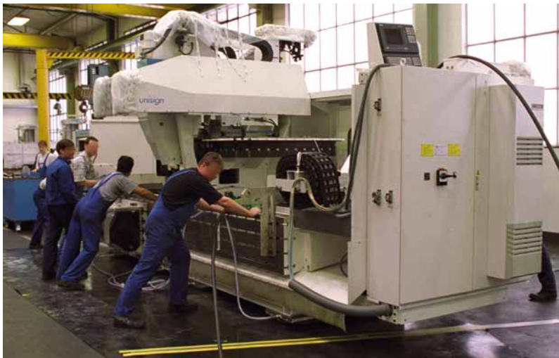
< Einbringen einer neuen Fräsmaschine Bringing in a new milling machine
